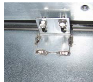
Figura 5: Conecte a unidade de derretimento aos trilhos em ambos os lados.
