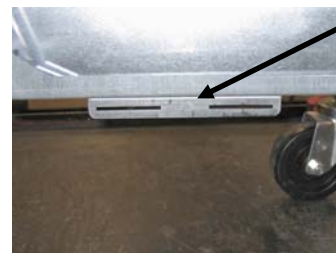
Figura 1: Conecte o suporte de alinhamento à base da barra da caixa ATO.
