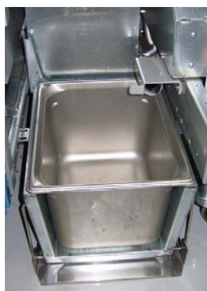
Figura 3: Insira a bandeja interna do reservatório de óleo na unidade de derretimento.
